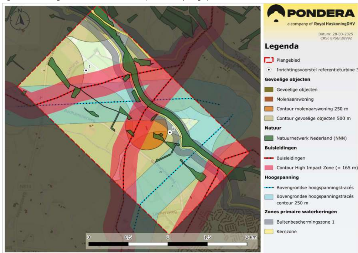
Figuur 3.3 Inrichtingsvoorstel referentieturbine 3 (250 meter tiphoogte)
