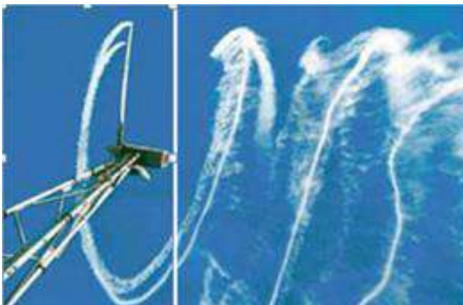
Figuur 3.2: Turbulentie door een windturbine (bron Riso National Laboratory, Denemarken)
