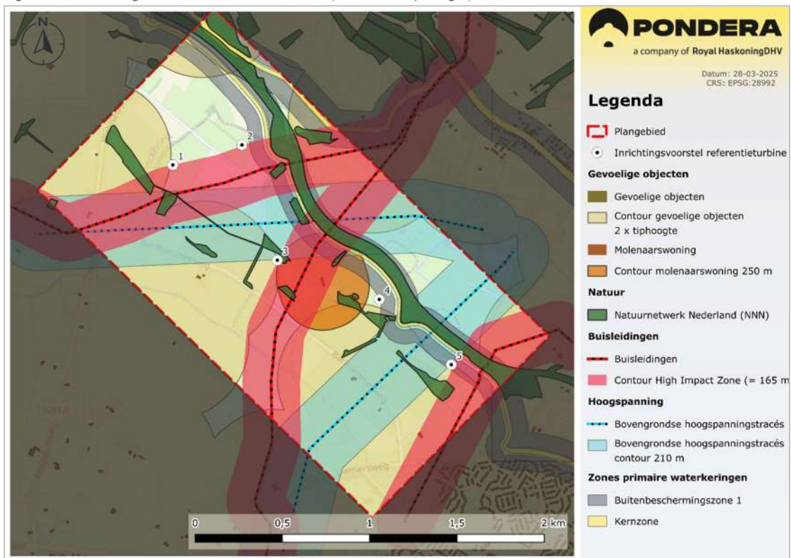
Figuur 3.1 Inrichtingsvoorstel referentieturbine 1 (210 meter tiphoogte)
