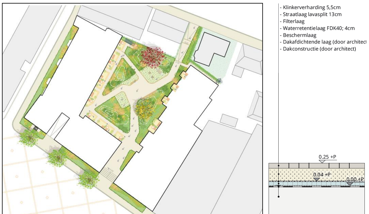
Figuur 4: Impressie groenplan en opbouw retentielaag op het dak van de parkeergarage.
