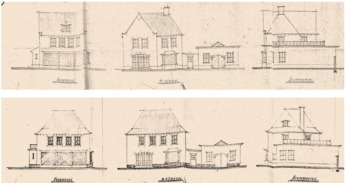
Figuur 20 Uitgevoerd ontwerp van het woonhuis met bedrijfsgedeelte: gevelaanzichten (niet op schaal)
