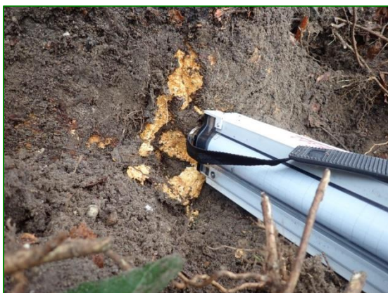
Foto 1: een resistograaf is een instrument waarmee de houtweerstand in stam, stamvoet en gestelwortels gemeten wordt
