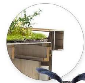
Holle dakrand zomervluchten voor vleermuizen aan de westzijde
