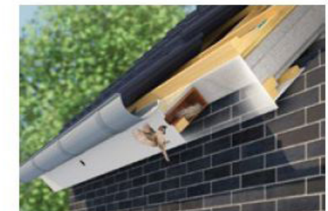
nestkasten in dakconstructie
