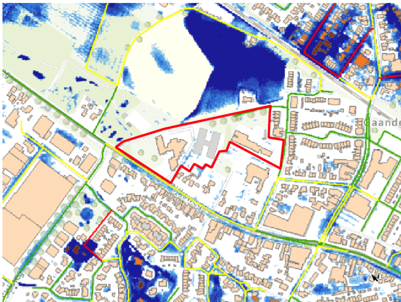
Figuur 9 Stresstest wateroverlast, bui kan 1x per 100 jaar
