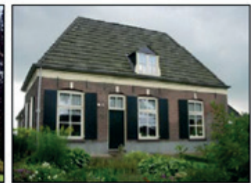
afgewolfd zadeldak (voorbeelden van mogelijke afgeleiden van een zadeldak)
