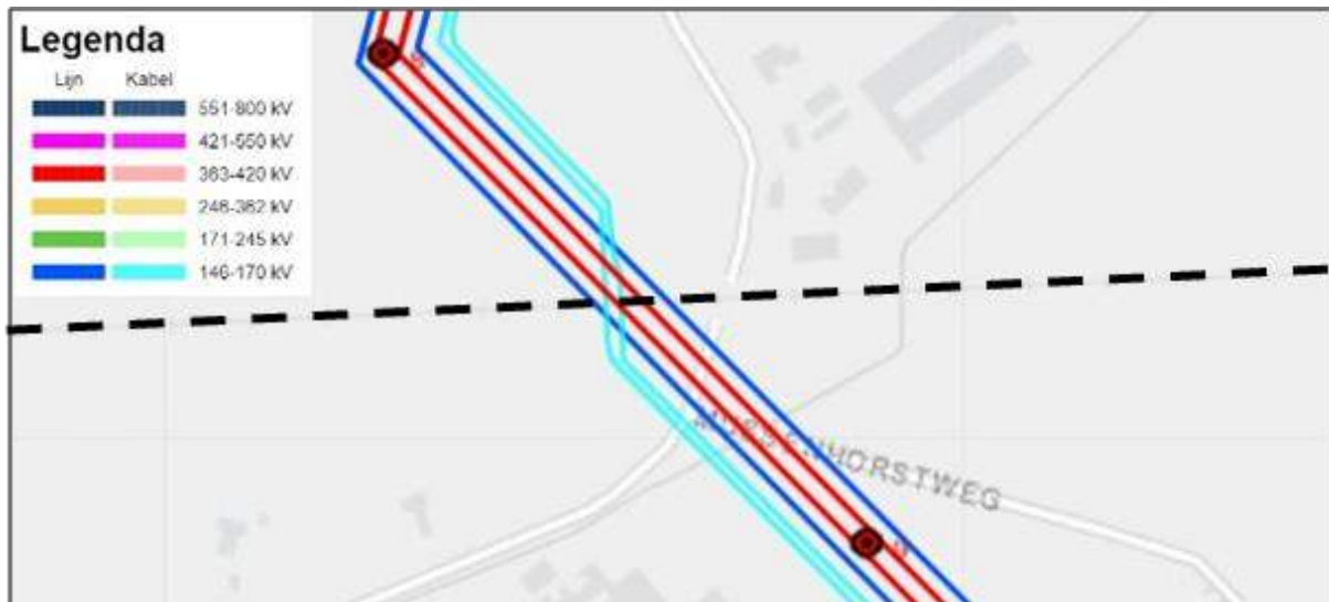
Figuur 11 Hoogspanningslijnen die het tracé kruisen ter hoogte spoorkilometer 37.9 (spoorlijn is zwarte onderbroken lijn).
