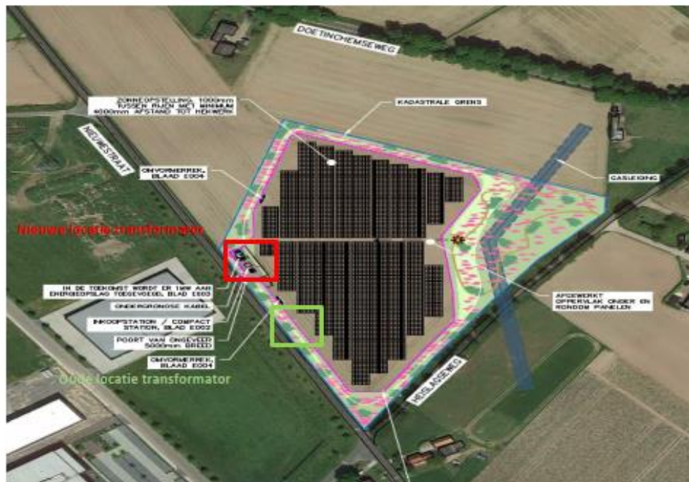
Figuur 1: Locatie transformator
