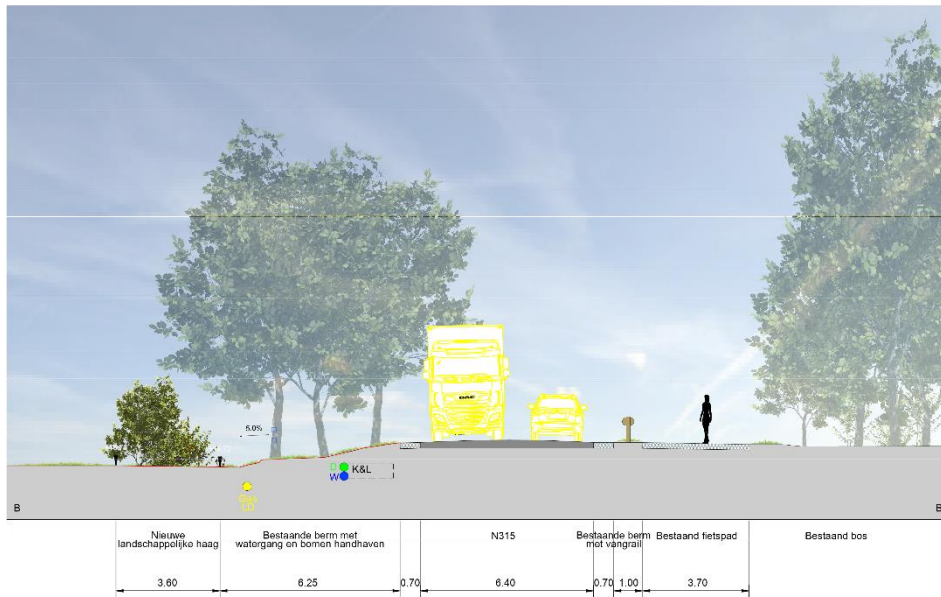
Figuur 54: dwarsprofiel B.
