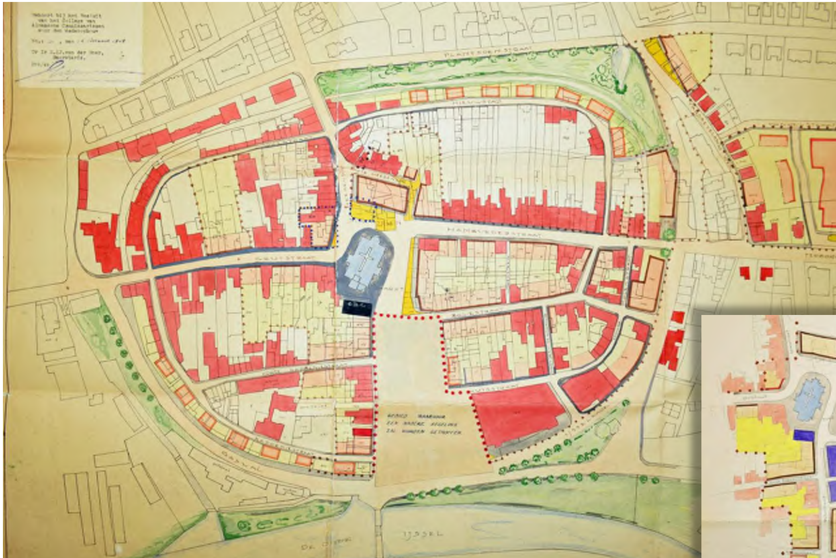
Wederopbouwplan van de stad zoals goedgekeurd in 1947. De bestaande bebouwing is rood, nieuw geprojecteerde bebouwing is oranje weergegeven. In geel zijn t.b.v. de invulling van openbare ruimte onteigende percelen gemarkeerd. Het terugleggen van de rooilijnen rond de kerk zorgde voor een betere doorstroming van het verkeer. De inzet rechts bevat het aanvullende wijzigingsplan voor het gedeelte ten zuidoosten van de Waterstraat.
