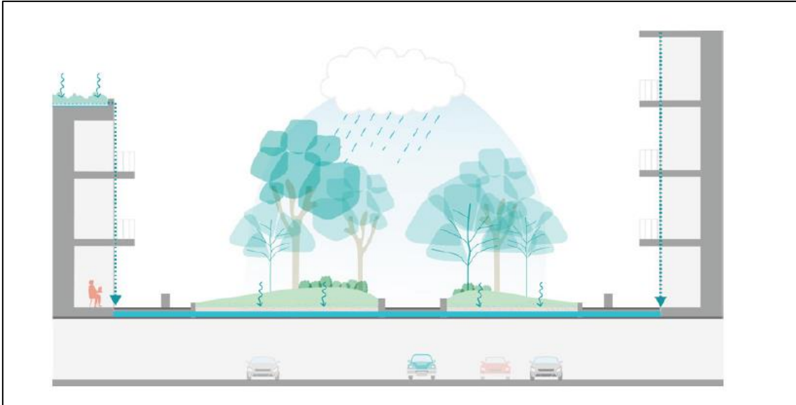
Schets waterberging via rententielaag boven parkeergarage
