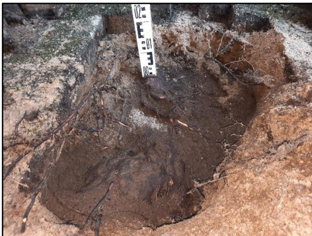
Figuur 17. Beworteling in proefsleuf.
