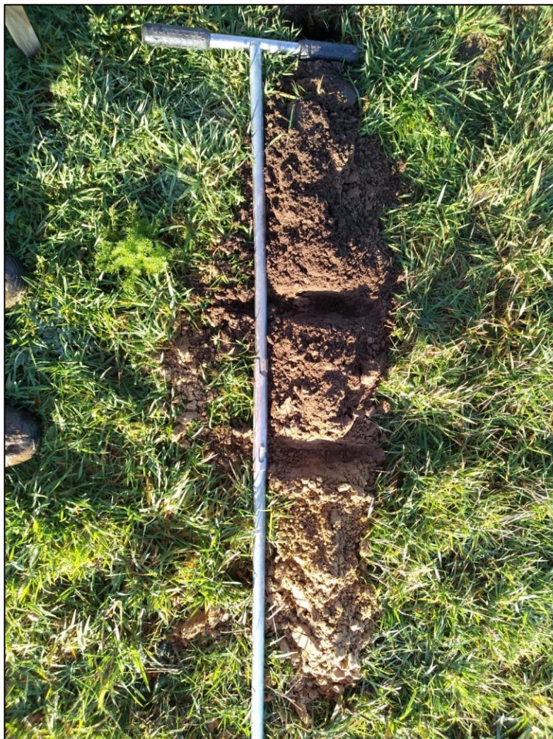
Afbeelding 12: Boorprofiel van boring 4 met vanaf het handvat naar beneden: de donkere bouwvoor, de eerdlaag en het iets roestige lichtgele dekzand (Ap-A-C profiel)
